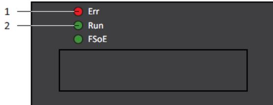
図50:EtherCAT状態のLED
